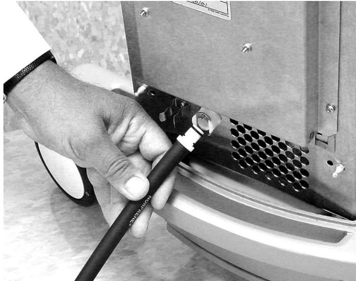
**Abbildung 8-3. Schlauch in das Ablassverbindungsstück drücken.**
