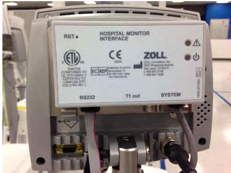
**Abbildung 4-80. Installiertes HMI – Rückseite Displaykopf**
