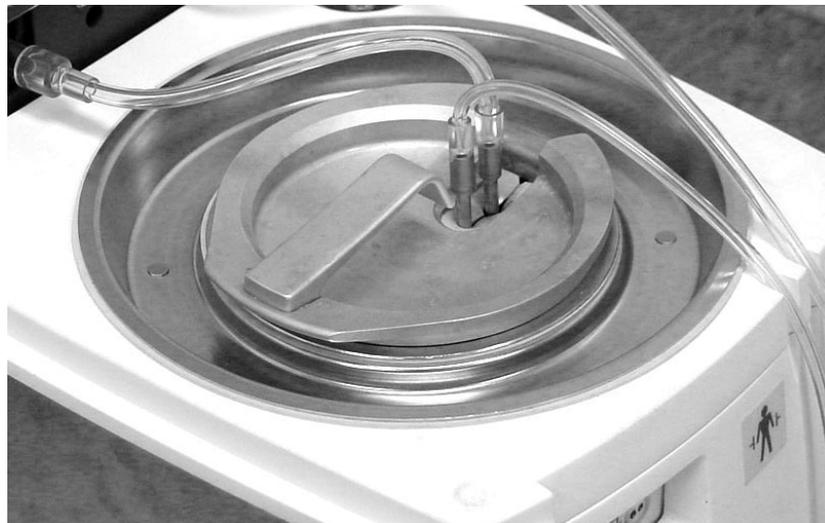
**Abbildung 4-44. Den Deckel wieder auf dem Kühlmittelbehälter anbringen.**
