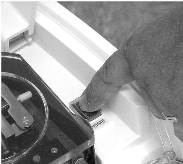
**Abbildung 4-47. Mit dem PRIME-Schalter den Schlauch vorfüllen.**
