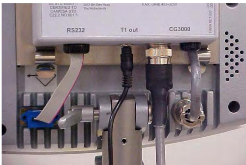
**Abbildung 4-75. HMIA mit Anschluss T1 out**
