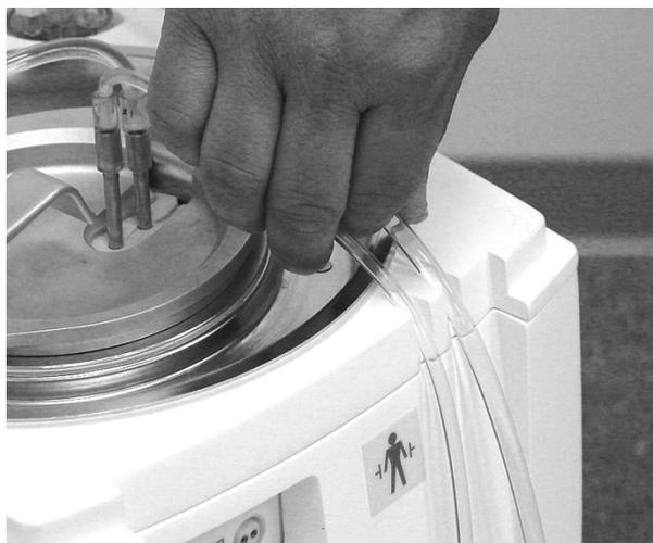
**Abbildung 4-48. Den Schlauch aus dem System herausführen.**
