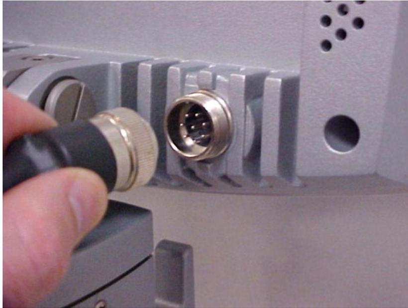
**Abbildung 3-5. Kontrollkabel in die Buchse einstecken.**
