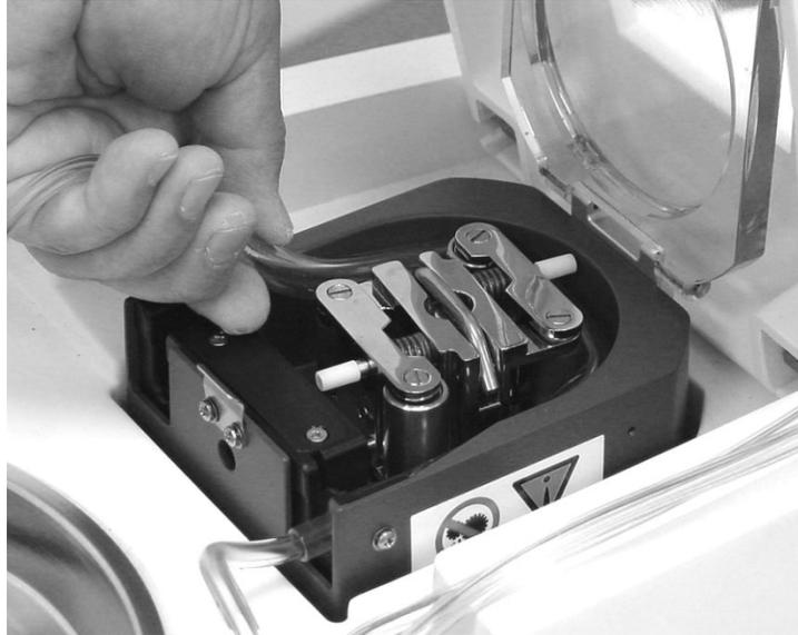
**Abbildung 4-43. Installation des Pumpenschlauchs.**
