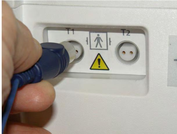
**Abbildung 4-50. Anschlüsse für die Temperatursonden.**
