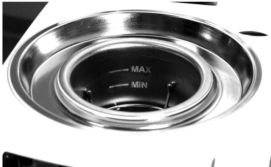
**Abbildung 4-37. Linien zur Anzeige des Flüssigkeitsstands im Kühlmittelbehälter.**
