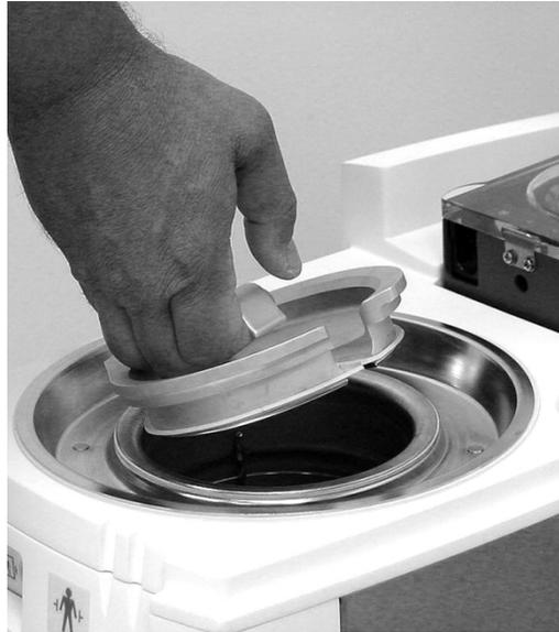
**Abbildung 4-36. Deckel des Kühlmittelbehälters.**
