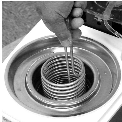
**Abbildung 4-39. Installieren der Wärmetauscherspule.**
