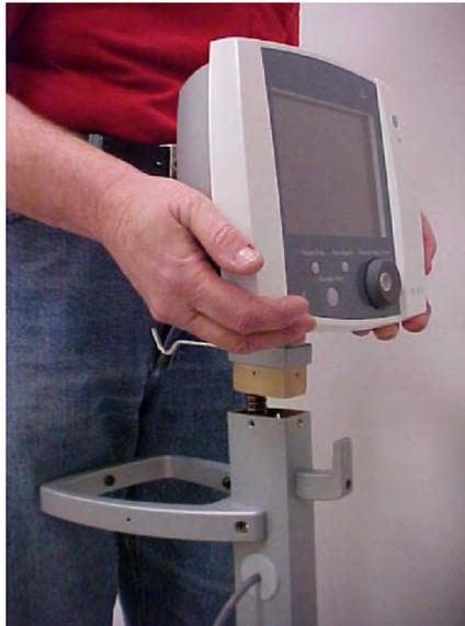
**Abbildung 3-4.** Anbringen des Kontrollkopfes an den Mast.
