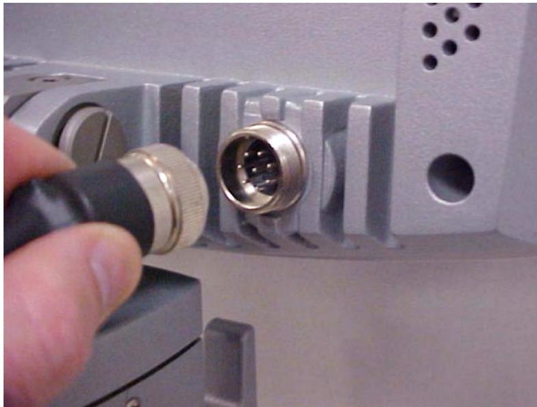
**Abbildung 4-78. Der Hirose-Verbinder – Rückseite des Displaykopfes**
